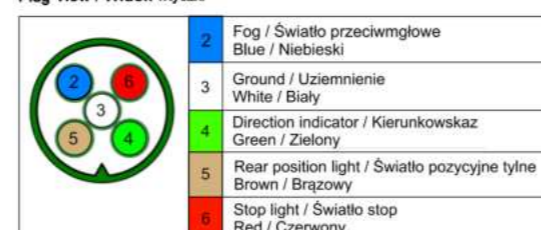
BAYONET 5 PIN Green / Zielony Plug view / Widok wtyczki
