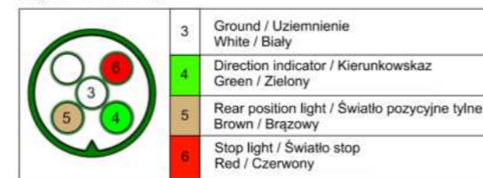
BAYONET 4 PIN Green / Zielony Plug view / Widok wtyczki
