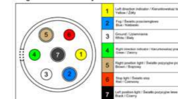
Socket 7 Pins / Gniazdo 7 Pinów Plug view / Widok od wtyczki
