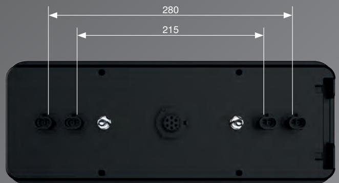
↳ sortie AMP + 4 sorties 2 PIN (type super-seal)
